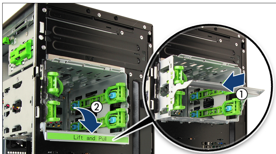
図 18: HDD ケージを押し込んで、レバーを倒す
