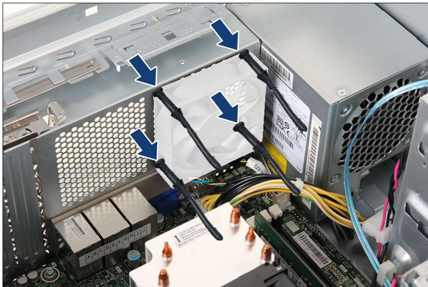
図 55: 新しいゴム製リベットの挿入
