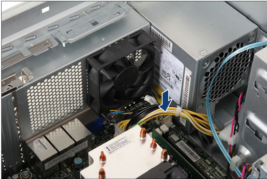
図 58: 背面ファンケーブルの接続
