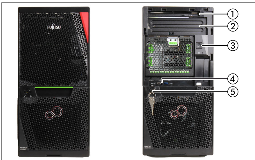
図 161: ベイカバー付きのサーバ前面（左側）とベイカバーなし（右側）
