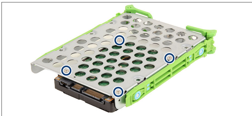
図 44: 2.5 インチ HDD を 3.5 インチ HDD 取り付けプレートから取り外す
