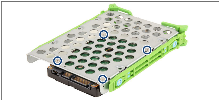
図 41: 2.5 インチ HDD の 3.5 インチ HDD 取り付けプレートへの取り付け
