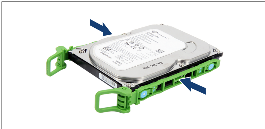
図 47: イージーレールの取り付け
