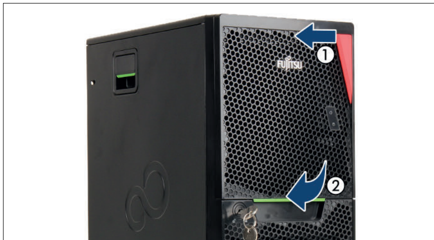
図 28: ベイカバーの取り付け
